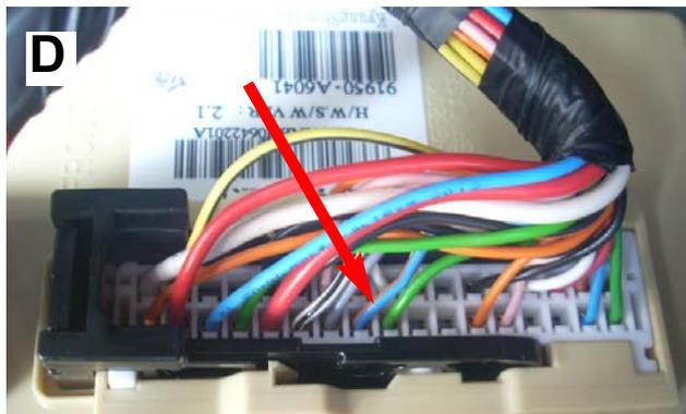
Interporre tra il filo **AZZURRO/VERDE** e il filo **ROSSO** del cablaggio allarme la resistenza da 4K7 ohm 1/4 w
